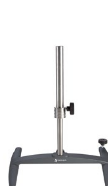
Stativo telescopico Ø tubo dello stativo 32 mm, altezza da 725 a 1.025 mm, distanza piedi 370 mm, peso 7,7 kg N. d'ordine 570-12100-00
