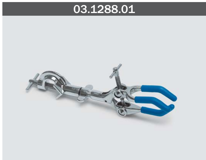
PINZA PER SOSTEGNO A 3 GRIFFE CON MORSETTO In lega pesante, con agraffi angolati e rivestiti in PVC e morsetto Apertura delle branche 0-80mm, lunghezza 230 mm, diametro del gambo 8 mm. CLAMP FOR STAND, WITH 3 JAWES AND BOSSHEAD Made of heavy alloy, with angled and PVC covered jaws, revolving bosshead. Opening jaws 0-80 mm, lenght 230 mm, stem diameter 8 mm.
