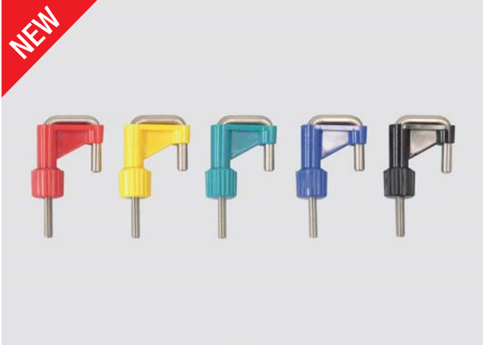
MORSETTO STRINGITUBO AUTOCLAVABILE Morsetto in acciaio inox e policarbonato, autoclavabile, per tubi con diametro fino a 21 mm. La manopola di regolazione consente un controllo del flusso molto preciso; il flusso può anche essere chiuso del tutto. Il tubo viene compresso su un'ampia superficie, in modo che non venga danneggiato. Il morsetto stringitubo può essere montato sui tubi flessibili anche dopo che sono stati collegati.
