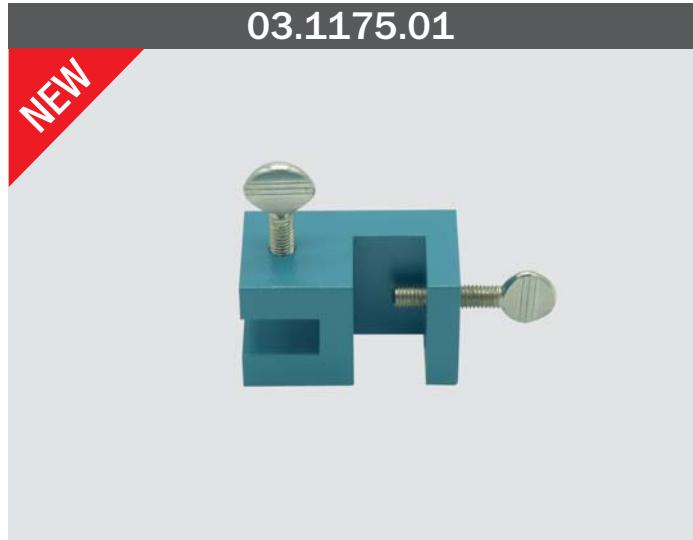
MORSETTO A CROCE IN ALLUMINIO PER PIANI Morsetto doppio a croce in alluminio per aggancio su superfici piane. Dimensioni delle due aperture: 15 mm e 22,5 mm. ALUMINUM CROSS CLAMP FOR TOPS Double cross clamp in aluminum for hooking onto flat surfaces. Dimensions of the two openings: 15 mm and 22.5 mm.
