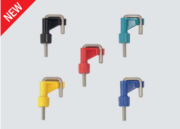
MORSETTO STRINGITUBO AUTOCLAVABILE - CLICK & CLOSE Morsetto in acciaio inox e policarbonato, autoclavabile, per tubi con diametro fino a 21 mm. I morsetti Click & Close possono essere aperti o chiusi senza dover essere completamente svitati. La manopola di regolazione consente un controllo del flusso molto preciso; il flusso può anche essere chiuso del tutto. Il tubo viene compresso su un'ampia superficie, in modo che non venga danneggiato. Il morsetto stringitubo può essere montato sui tubi flessibili anche dopo che sono stati collegati.
