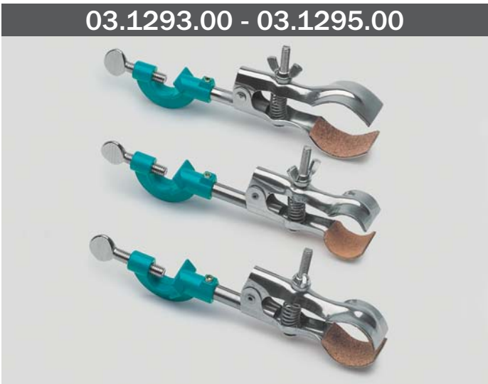
PINZA PER SOSTEGNO A BRACHE CURVE, CON MORSETTO GIREVOLE In acciaio inox, adatta per sostenere i palloni, rivestimento interno delle branche in pvc per una tenuta della presa più efficace, apertura massima del morsetto 16 mm. CLAMP FOR STAND, WITH CURVED PRONGS, WITH BOSSHEAD Made of stainless steel, suitable for supporting flasks; prongs covered in pvc to ensure a better grip, maximum opening of bosshead 16 mm.
