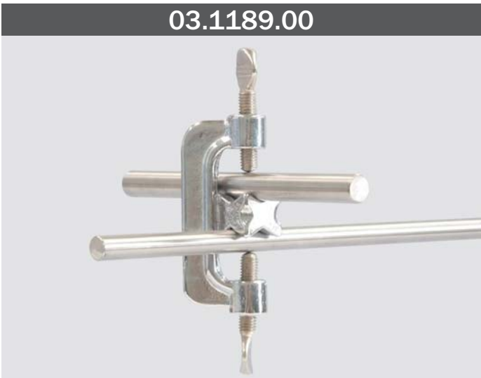
MORSETTO DOPPIO A CROCE In ottone cromato, con viti di bloccaggio. DOUBLE CROSS CLAMP Made of chromed brass, with fastening screws. Apertura | Opening 21 mm
