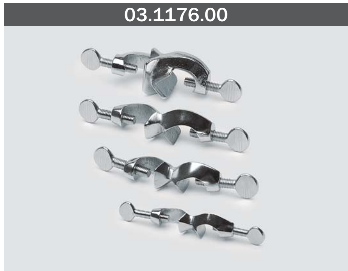
MORSETTO DOPPIO CON VITI DI BLOCCAGGIO In ottone cromato. DOUBLE CLAMP WITH FASTENING SCREWS Made of chromate brass. Apertura | Opening 13 mm
