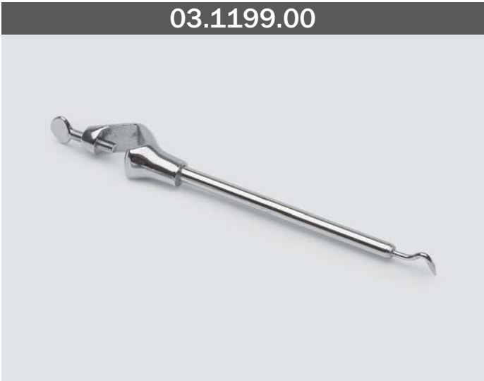
MORSETTO CON ASTA A GANCETTO In ottone cromato, per aste con un diametro fino a 18 mm, manico con diametro 8 mm. CLAMP WITH HOOK ROD Made of chromed brass, for rods with a diameter up to 18 mm, handle with a diameter of 8 mm.
