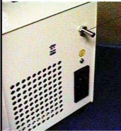
A richiesta viene fornito un portagomma da 1/4" da inserire al posto del silenziatore in caso di utilizzo della pompa come compressore. Massima pressione di esercizio 3 bar.
