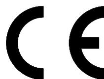
Questo apparato è stato progettato, costruito e testato secondo la Direttiva Europea 2004/108/CE (compatibilità elettromagnetica EMC), alla Direttiva Europea 2006/95/CE (bassa tensione BT) e alla norma CEI EN 61010-1:2011.
