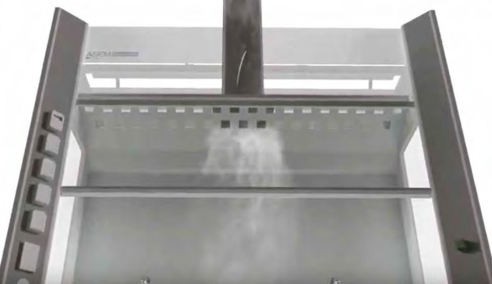
2) Il sistema si basa su un controllo elettronico che, impostata una velocità costante di aspirazione normalmente da 0,3 a 0,7 m/s, regola mandando un segnale alla valvola motorizzata che si aprirà e/o chiuderà in funzione della posizione del saliscendi.
