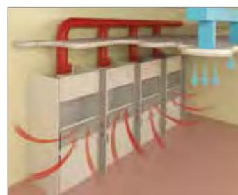
Controllo automatico, tramite microprocessore, del sistema di aspirazione e compensazione dell'aria di un laboratorio con una o più cappe
