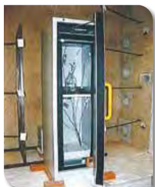
Armadio CHEMISAFE FIRE MY11 PRIMA del test di resistenza al fuoco.
