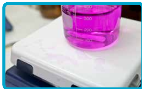
Piattello in vetroceramica a elevata resistenza chimica
