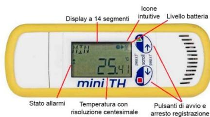
Figura 29: Interfaccia del dispositivo
