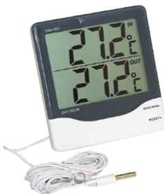
Termometro digitale con doppio display e due sonde di lettura: interna e esterna. Campo di misura: interna -5...+50 °C, esterna -50...+70 °C. Risoluzione 0,1 °C. Possibilità di richiamare le temperature Min/Max. Possibilità di fissaggio a muro o a pannello. Lunghezza della sonda esterna 3 m. Commutatore °C/°F. Dimensioni 100x110x18 mm, peso 150 g. Alimentazione a pila AAA 1,5V.
