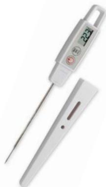
Adatto per il settore alimentare. Sonda in acciaio per penetrazione. Calibrazione manuale a 0 °C. Diametro terminale sonda mm 3. Dimensioni 220x20x15 mm, peso 50 g. Autospegnimento e pulsante di fermo lettura. Precisione  $\pm 0,5$  °C (da -10 a 100 °C, oltre  $\pm 1$  °C). Pulsante ON/OFF e °C/°F. Alimentazione a pila. Marchio CE. Prodotto ISO9001. Istruzioni in italiano.
