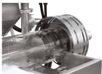
Flangia con inserto per protezione contro il calore radiante (pacchetto di gasaggio 15)
