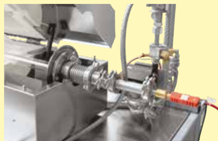
Giunto rotante a tenuta di gas con raffreddamento gas e termocoppia carica
