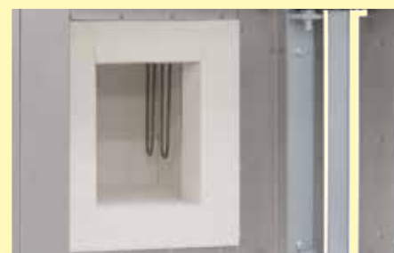
Isolamento in mattoni refrattari leggeri ed elementi riscaldanti in disilicuro di molibdeno
