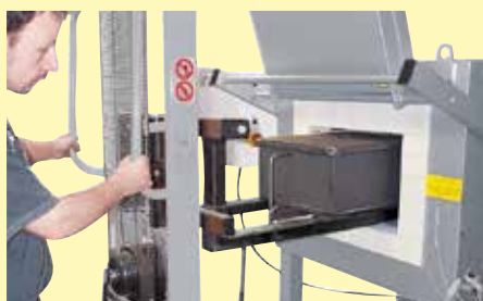
Lavoro con cassetta di cottura per l'atmosfera gassosa protettivi mediante l'ausilio di un carrello di carico
