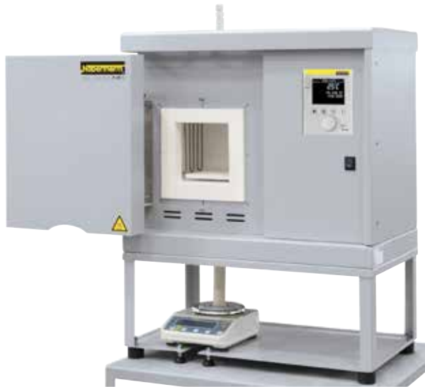
Forno ad alta temperatura LHT 04/16 SW con bilancia per determinare la perdita di peso
