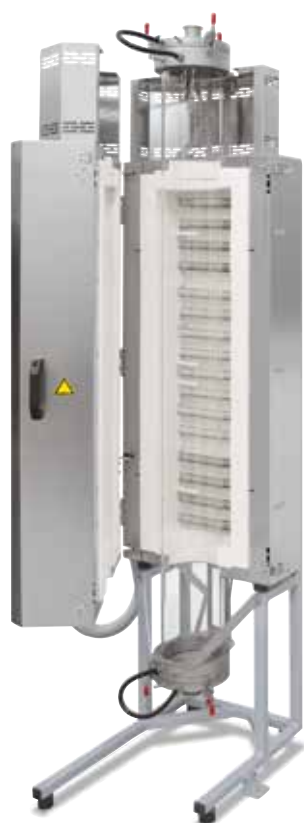
Forno tubolare RSV 170/1000/11 con tubo di lavoro in vetro di quarzo a tenuta di gas e flange sottovuoto raffreddate ad acqua
