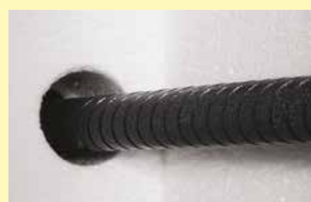
Camera forno con materiale in fibra pregiato e barre di riscaldamento SiC ai due lati
